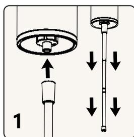
1 ステンレス管を接続し、引き出して調節します。
