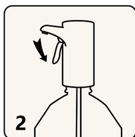
スイッチを下ろして電源を入れ、ディスペンサーをボトルの口に接続します。
