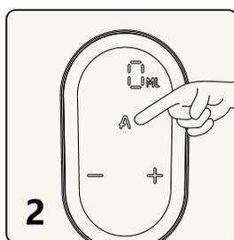
2 Aボタンを操作してエアレーションのON/OFFを選択してください。
