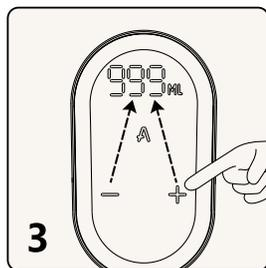
3 定量を調整します。1~999mlの範囲で1mlずつ定量化可能
